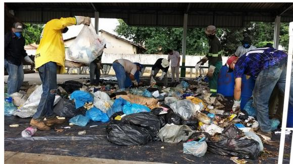
Foto 18: Abertura de todos os sacos para a separação dos resíduos por tipo para posterior pesagem.
