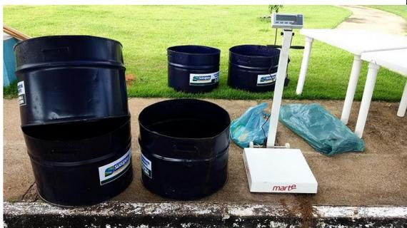
Foto 41: Tambores e balança utilizados na pesagem em Sucupira.
