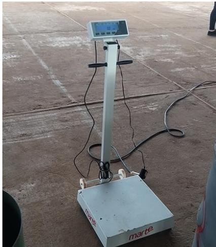
Foto 70: Balança utilizada para a pesagem dos resíduos.
