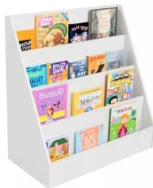
**ESTRUTURA:** Confeccionado em melamínico MDP de espessura mínima de 15 mm, revestido em laminado melamínico de baixa pressão texturizado em ambas as faces. Acabamento em fita de borda de PVC de 2 mm de espessura em todo o contorno da peça com raio de 2,5 mm nas arestas superior e inferior da borda, na mesma cor do MDP. Deverá ter resistência a impactos, riscos e abrasão e perfeitamente fixada no tampo. Cor branco.
